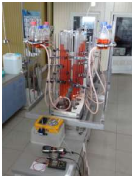
Fot. 2. Stanowisko do badań eudiometrycznych
