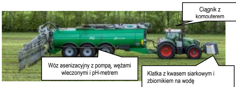
Fot. 8. Wóz asenizacyjny z oprzyrządowaniem do zakwaszania gnojowicy „na polu” (fot. Henning Foged, enAgro)
