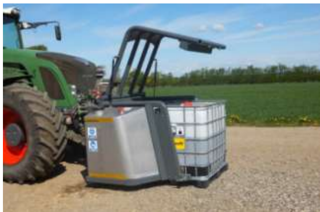
Fot.10. Wymiana pojemnika z kwasem (1 pojemnik=1000 l= 1840 kg kwasu siarkowego) (fot. Henning Foged, Agro Dania)
