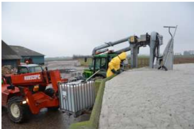
Fot. 8. Wóz asenizacyjny z oprzyrządowaniem do zakwaszania gnojowicy „na polu” (fot. Henning Foged, enAgro)
