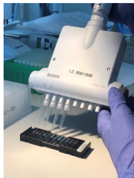
Fot. 2. Nakładanie prób na mikromacierz EuroG MD
