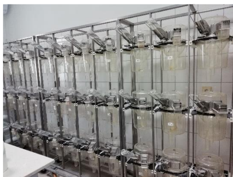
Fot. 3 i 4. Klatki bilansowe dla szczurów (fot. B. Szymczyk)
