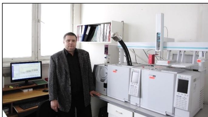
Ryc. 8. GC/MS – Chromatograf gazowy ze spektrometrem mas
