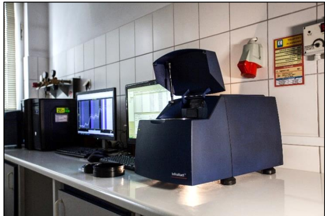
Ryc. 13. NIRS – spektrometr do analiz w bliskiej podczerwieni
