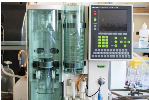
Ryc. 5. Aparat Kjeldahla do oznaczania białka
