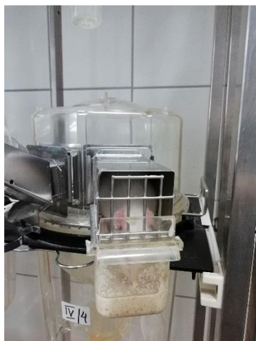
Fot. 3 i 4. Klatki bilansowe dla szczurów (fot. B. Szymczyk)
