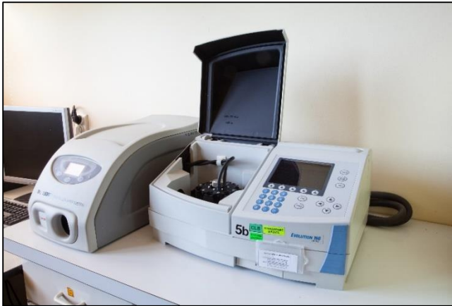
Ryc. 12. Spektrofotometr – oznaczanie jodu
