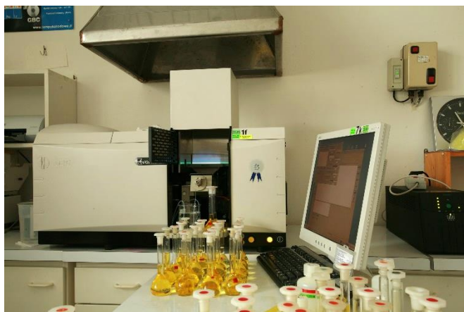
Ryc. 10. AAS – spektrometr absorpcji atomowej – oznaczanie składników mineralnych
