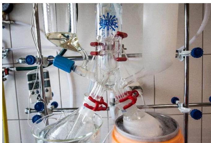
Ryc. 18. Doświadczenie na gęsiach kołudzkich – przygotowanie próbek techniką SAFE – analizy związków lotnych
