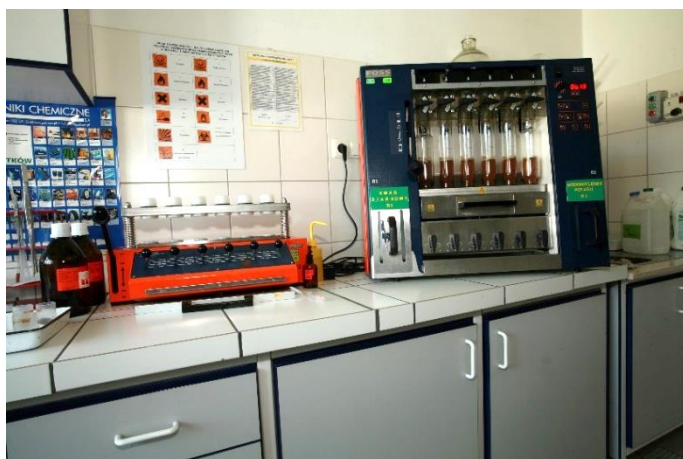
Ryc. 6. Aparat Teator do oznaczania włókna
