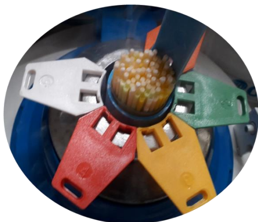
Ryc. 16. Kontener ze słómkami w ciekłym azocie
