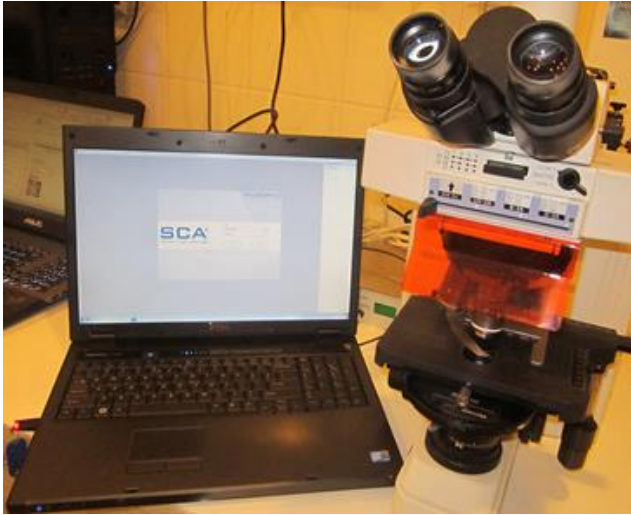
Ryc. 2. Urządzenie komputerowe – Computer Assisted Sperm Analysis (CASA)
