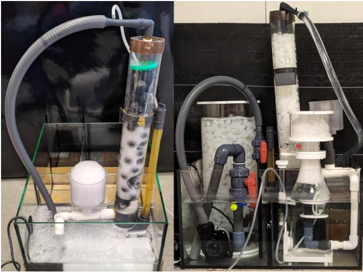
Ryc. 9. Zbiorniki doświadczalne do testowania filtracji biologicznej opartej o ruchome złoża na bazie konstrukcji T-Aqua oraz do testowania różnych konstrukcji odpieniaczy
