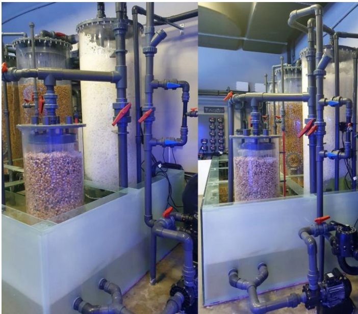
Ryc. 10. W pełni funkcjonujące filtry biologiczne produkcji T-Aqua
