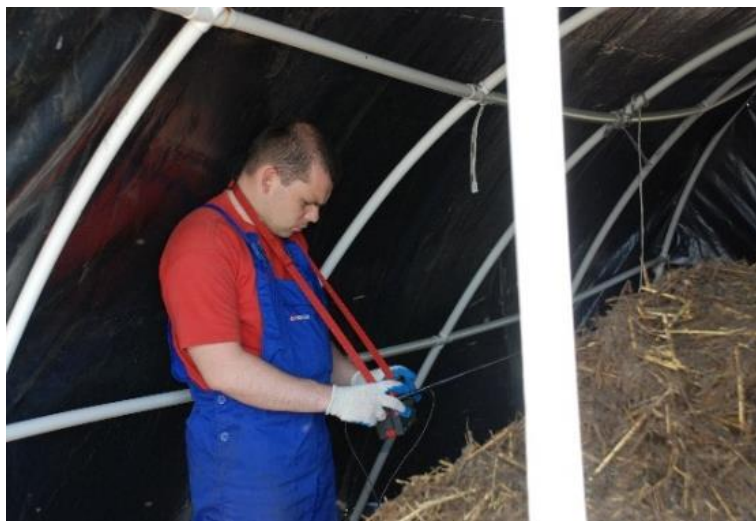
Fot. 43. Dr Tomasz Pająk w trakcie pomiarów emisji gazów z obornika przy pomocy autorskiej metody tunelu aerodynamicznego. ZD IZ PIB Żerniki Sp. z o.o. (fot. J. Walczak)
