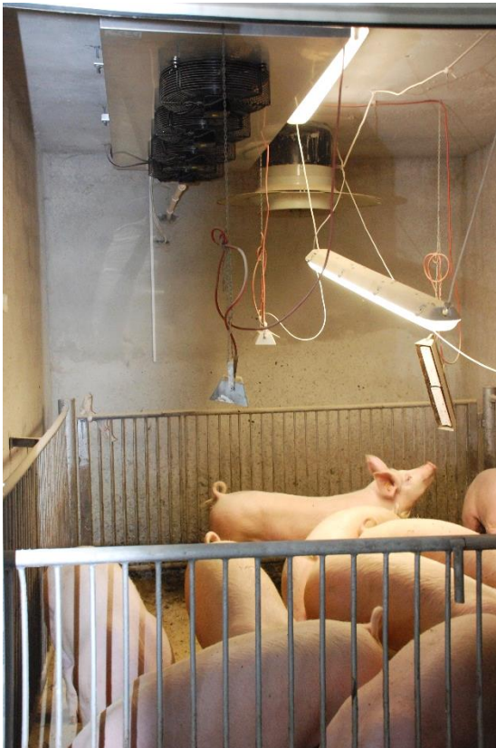
Fot. 32. Komory mikroklimatyczne do badań emisji GHG i amoniaku. Widoczna instalacja do schładzania powietrza do -30^{\circ}\text{C} . ZD IZ PIB Rudawa Sp. z o.o. (fot. J. Walczak)
