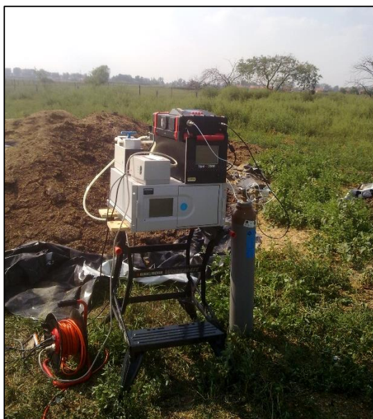
Fot. 29. Pomiary emisji GHG i amoniaku z mieszanek kompostowych. ZD IZ PIB Chorzelów Sp. z o.o. (fot. J. Walczak)
