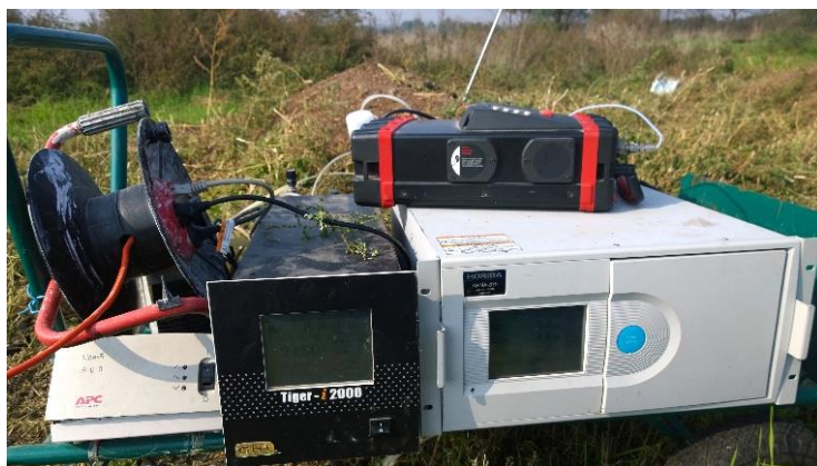
Fot. 34. Przenośna aparatura do pomiaru emisji GHG (fot. J. Walczak)
